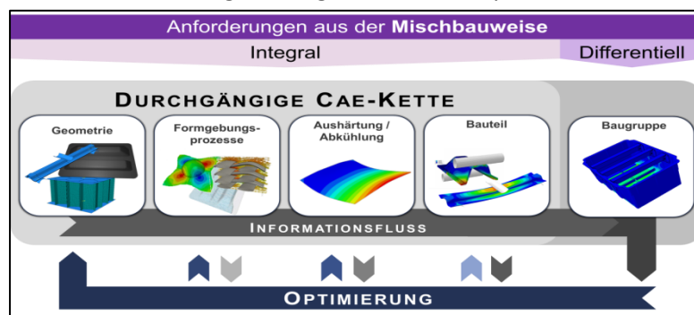
Abb. 12: durchgängige CAE-Kette für faserverstärkte Kunststoffbauteile
