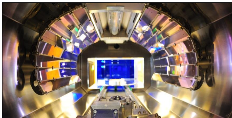
Abb. 9: UV- Aggregat zur Beschichtung von 3D-Teilen
