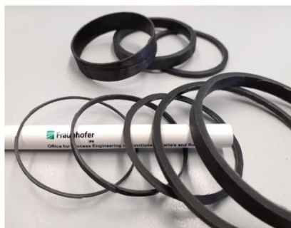
Zuschnitt von dünnwandigen CFK-Rohren mit Wandstärken unter 1mm
